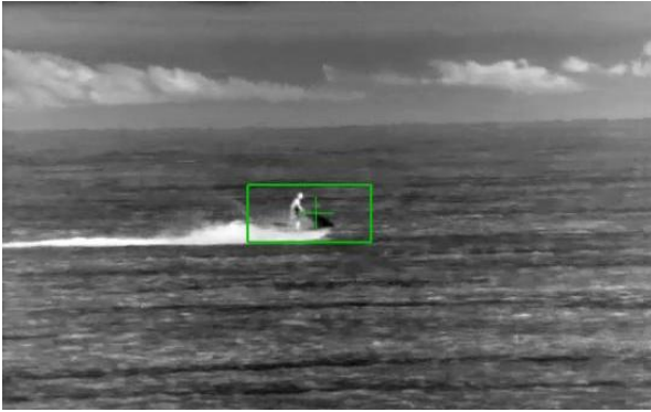
Tracking a jet-ski using IR video
