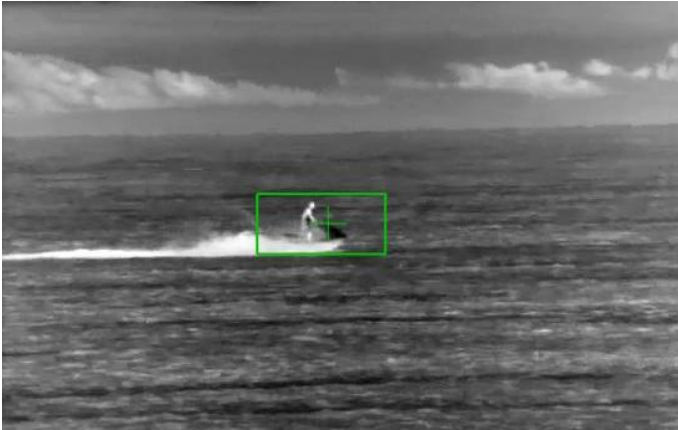
Tracking a jet-ski using IR video
